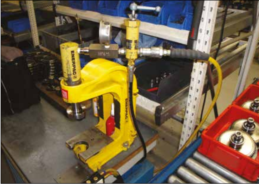
▲ Vérin RC308 monté dans une col de cygne d'établi A-330 actionnée par une pompe à air PATG-Turbo pour le pressage contrôlé des paliers pour les pignons des machines à tisser. La soupape de sécurité V152 contrôle la pression appliquée.
