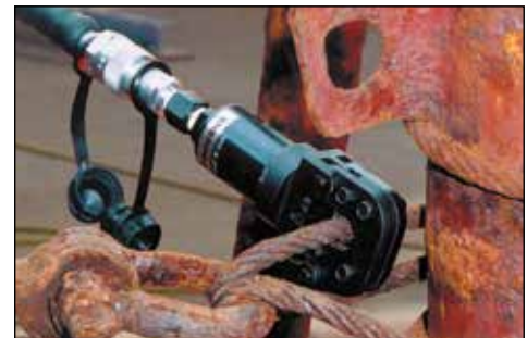
Un câble en acier se coupe facilement grâce à l'action guillotine fluide d'une cisaille Enerpac. ▶
