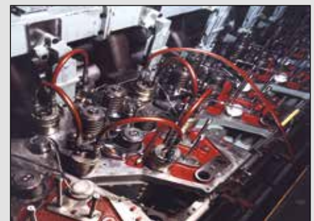
▲ Écrous hydrauliques sur moteur diesel
