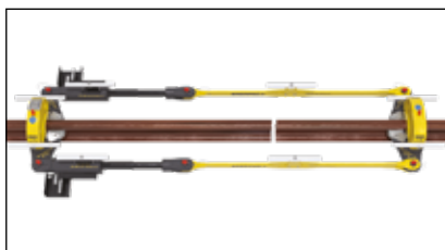
▲ Tendeur modulaire 70 tonnes, maintient le rail de longueur neutre pendant le processus de soudage.
