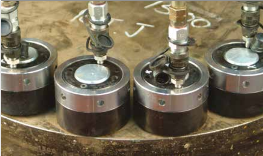
▲ Mise en tension avec écrous hydrauliques
