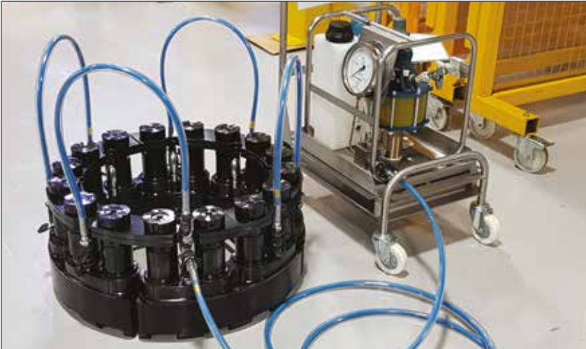
▲ Installation de la mise en tension multigoujon.
