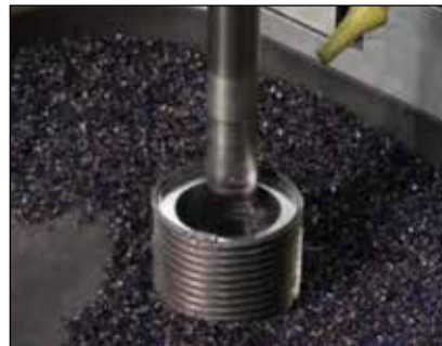
▲ Noyautage du centre d'un boulon (diamètre intérieur).
