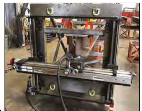
Fresatura frontale di trave ad H con una GMRF1000. ►
