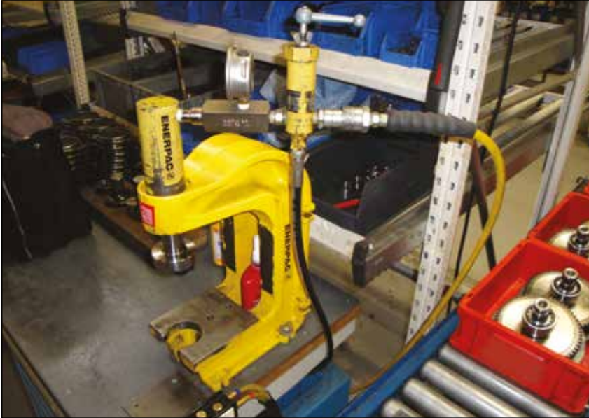
▲ Cilindro RC308 montato su pressa a collo di cigno A330 alimentato da una pompa pneumatica PATG per una pressatura controllata dei cuscinetti nei pignoni delle macchine tessili. La forza di compressione è controllata tramite una valvola regolatrice di pressione V152.
