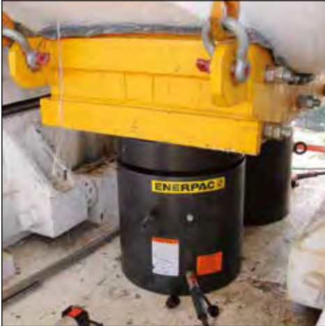
▲ Sollevamento di carichi pesanti e livellamento di fondazioni. La ghiera di sicurezza trattiene il carico meccanicamente per lungo tempo.
