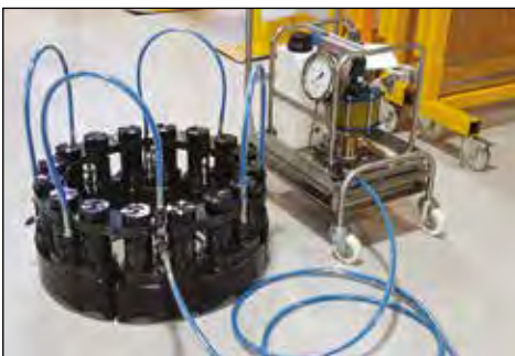
◀ Sistema Enerpac per il tensionamento di più bulloni (MST, Multi Stud Tensioning), in grado di tensionare simultaneamente tutti i bulloni di un giunto.
