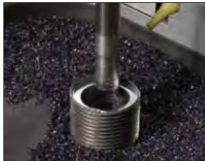
▲ Foratura del centro di un bullone (diametro minore).
