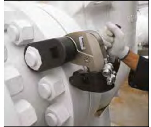
▲ Chiave dinamometrica S11000X modificata con inserto e rullo di reazione su misura.
