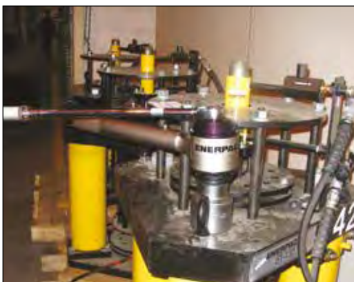
◀ La leva di reazione Enerpac per il moltiplicatore di coppia E393 è utilizzata per serrare manualmente bulloni con coppia di serraggio fino a 4300 Nm.
