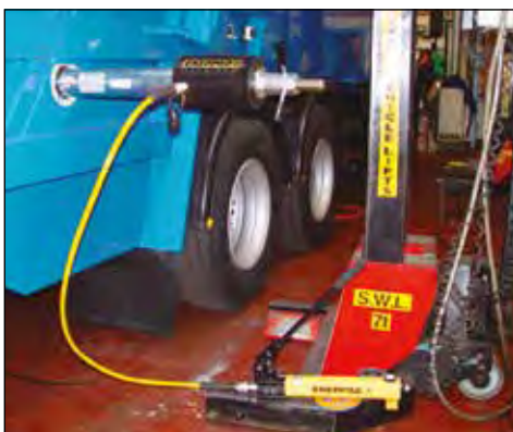
◀ Un RACH306 azionato da una leggerissima pompa a mano P392, utilizzato per estrarre spine corrose dal telaio di veicoli per raccolta rifiuti.
