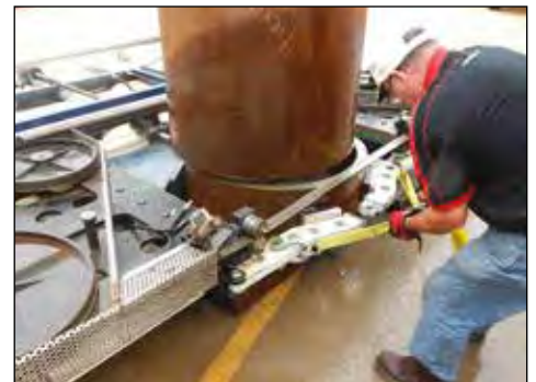
▲ Taglio di tubi con sega a nastro portatile BS.
