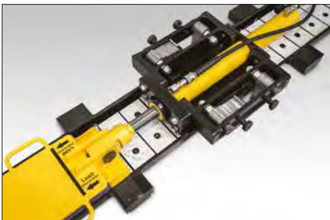
◀ Dettagli dell'unità di spinta-trazione del sistema LH400.
