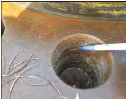
▲ Una filettatura tipica prima della rigenerazione
