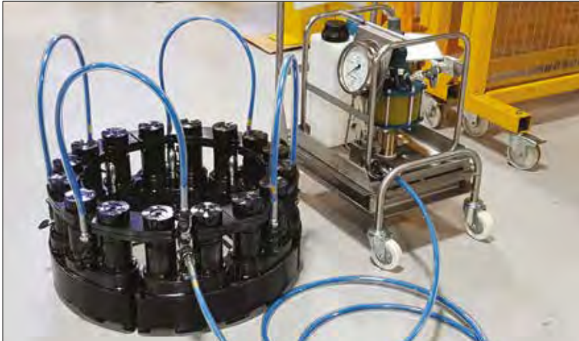
▲ Allestimento per il tensionamento di più bulloni.
