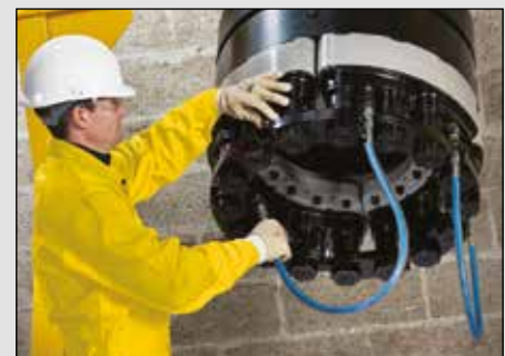
▲ Anwendungsbeispiel für das Vorspannen von mehreren Bolzen.
