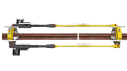
▲ Modularer 70 t-Spanner hält die Schiene während des Schweißprozesses in neutraler Länge.
